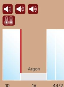
**Double vitrage thermique + acoustique renforcée**
