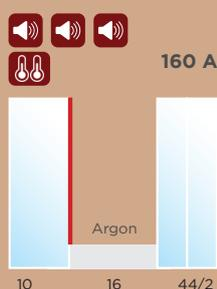
**Double vitrage thermique + acoustique renforcée**
